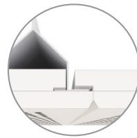
CORRIDOR Techo autoportante, sin perfil Borde D
